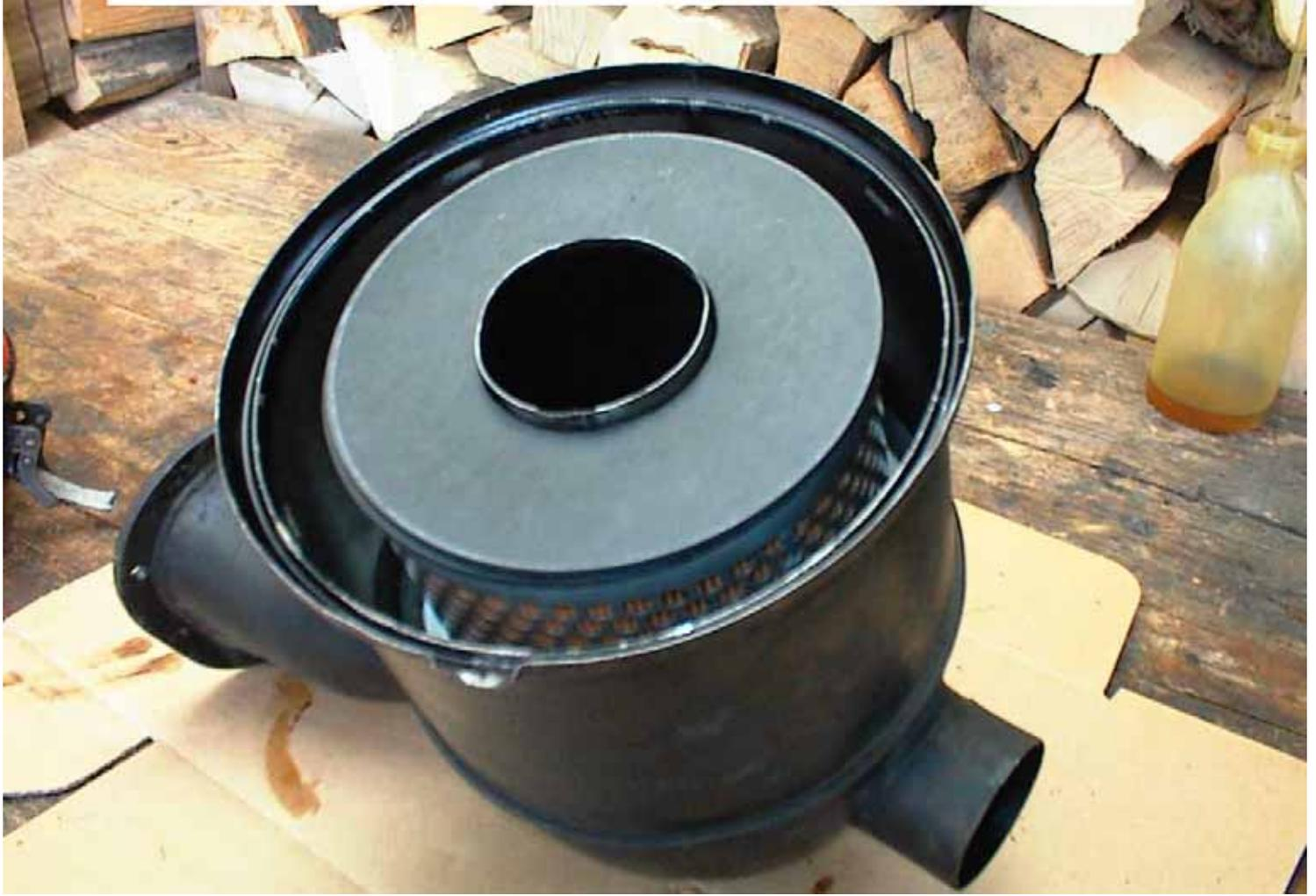
Bild 10 : originalen Filteruntertopf aufsetzen
