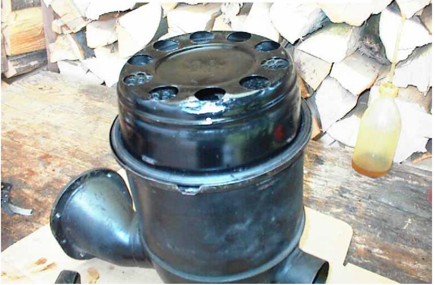
Bild 11 : Filteruntergehäuse aufsetzen
