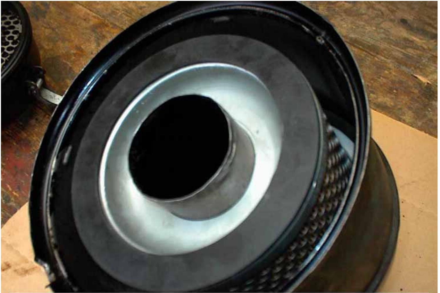
Bild 7 : Moosgummi ölen und vorsichtig ins Gehäuse einführen, mit einem Holz nachhelfen
