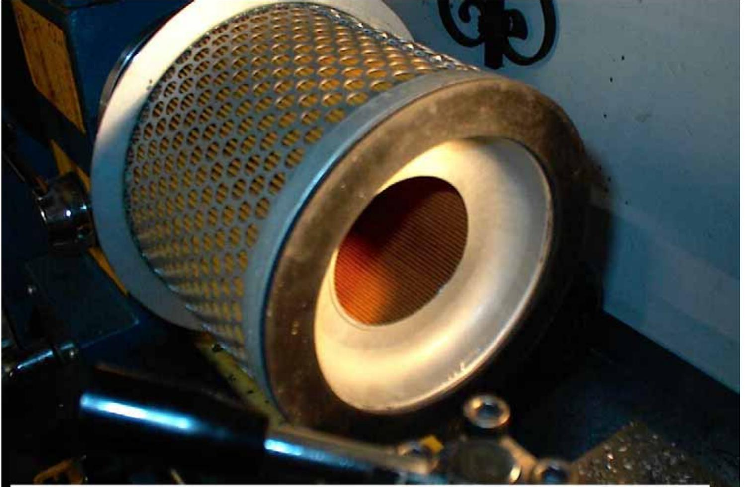
Bild 4 : Filterboden auf D=68mm aufdrehen, und eine 3mm Gummidichtung aufkleben
